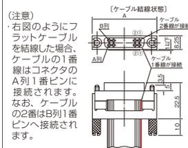
※FCNコネクタの圧接作業はメーカー指定の専用工具をお使い下さい。試作などの為の暫定的なものであれば、バース(万力)や簡易工具(06307ページ)での接続も可能です。簡易工具の使用方法は03052ページのHIF3Bシリーズのページにて参照してください。同じ方法で圧接ができます。ただし圧接品質にはバラツキが生じますのでご注意ください。なおミスミではこちらの商品のハーネス加工もしております。専用工具にて作業してありますので品質のバラツキがなく信頼性の高いハーネスに仕上がります。
