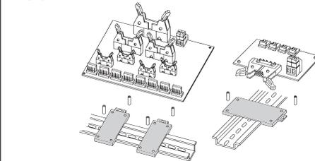
センサー、スイッチ、リレーなどの配線中継ユニットやモジュールをDINレールに並べて配置する時に利用します。
